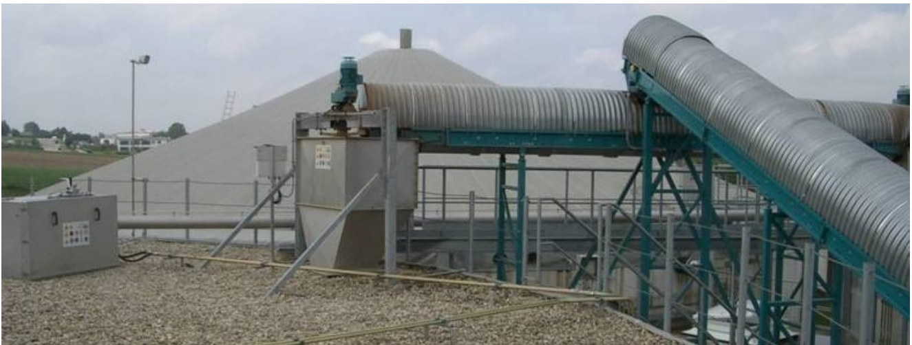
Abb. 16: Feststoff-Trocken-Eintragungssystem mit Steigförderband, Querförderband und Stopfschnecke (Foto: Gutachtergemeinschaft Biogas GmbH)
