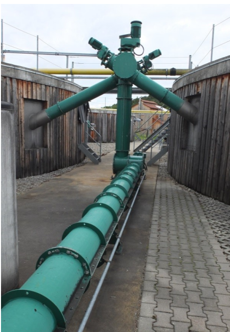
Abb. 14 und 15: Feststoff-Trocken-Eintragssysteme mit Trog-, Steig- und Stopfschnecke (Fotos: LfL)
