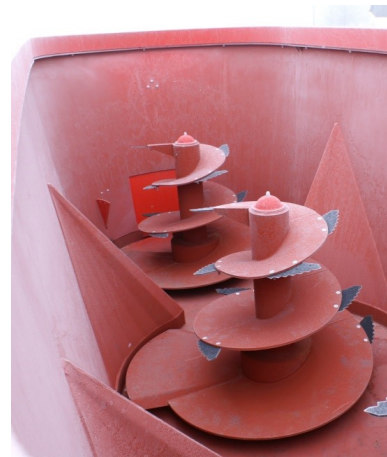
Abb. 10 und 11: Vorlagebehälter mit stehenden Intensiv-Mischschnecken (Fotos: LfL)
