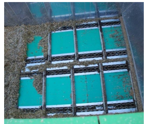
Abb. 4 und 5: Container mit Kratzboden (Foto links: LfL; Foto rechts: Gutachtergemeinschaft Biogas GmbH)
