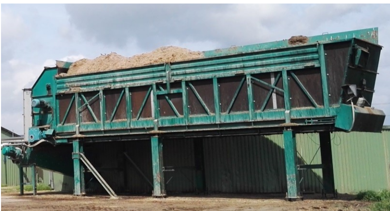
Abb. 4 und 5: Container mit Kratzboden (Foto links: LfL; Foto rechts: Gutachtergemeinschaft Biogas GmbH)
