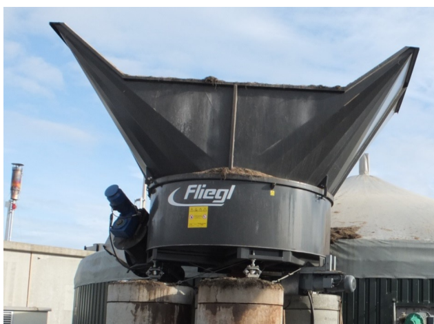
Abb. 9: Rundcontainer mit Austragsschwert (Foto: LfL)
