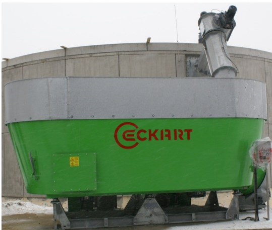
Abb. 10 und 11: Vorlagebehälter mit stehenden Intensiv-Mischschnecken (Fotos: LfL)
