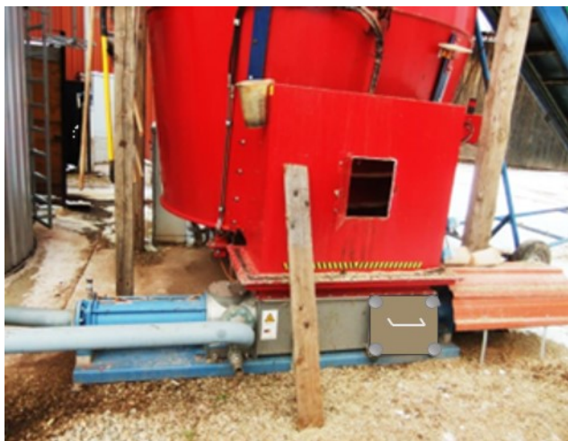
Abb. 17 und 18: Feststoff-Flüssig-Eintragssystem mit Exzentrerschneckenpumpe; SICHERHEITSHINWEIS: Vor Inbetriebnahme des Aggregats ist die Wartungsklappe zu verschließen (siehe Bildmitte)! (Foto: LfL).
