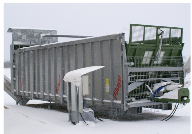
Abb. 7 und 8: Container mit Abschiebesystem (Foto links: Gutachtergemeinschaft Biogas GmbH; Foto rechts: LfL)
