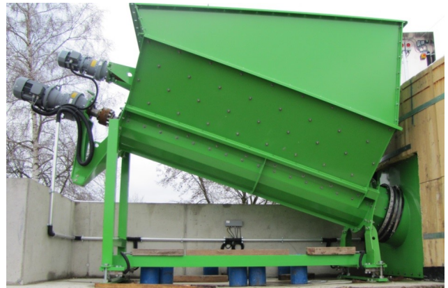
Abb. 3: Trichter mit Schneckeneintrag (Foto: LfL)
