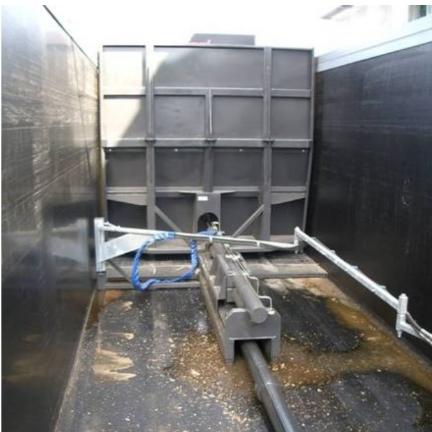
Abb. 7 und 8: Container mit Abschiebesystem (Foto links: Gutachtergemeinschaft Biogas GmbH; Foto rechts: LfL)
