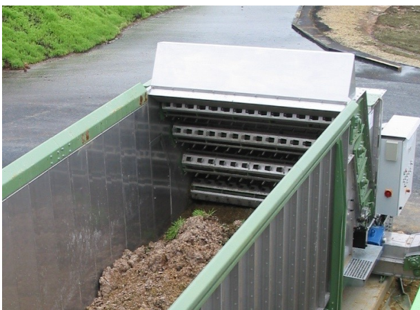
Abb. 12 und 13: Feststoffvorlagebehälter mit Auflöse- bzw. Mischwalzen (Fotos: LfL)
