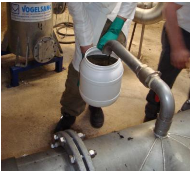
Abb. 3: Entnahme von flüssigen Proben aus Entnahmestutzen und Ablaufhähnen
