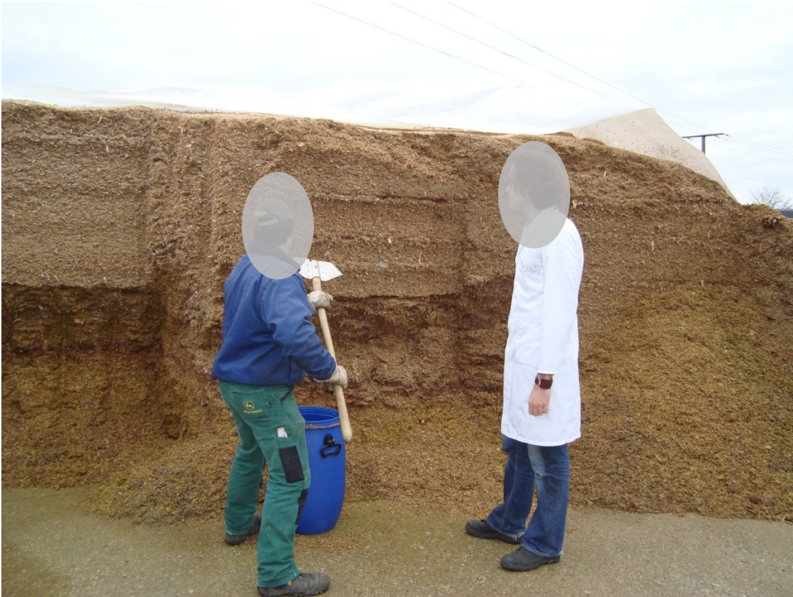
Abb. 5: Probenahme an der Schnittkante des Silos (Foto: G. Henkelmann, AQU 2, Qualitätssicherung und Untersuchungswesen)
