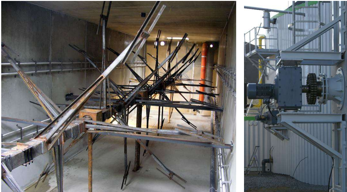
Abbildung 13: Haspelrührwerk in einem liegenden Fermenter mit Antriebseinheit (Foto: Novatech / LfL)
