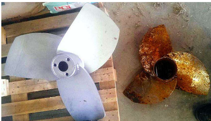
Abbildung 1: Gegenüberstellung von neuem und verschlissenen Propeller eines Schnellläufers
