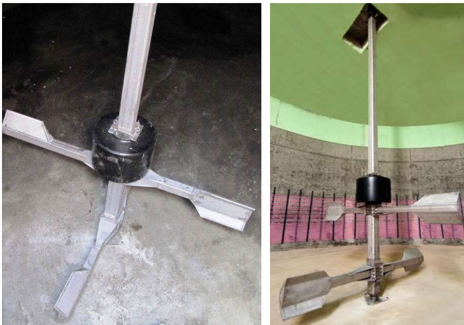
Abbildung 12: Vertikales Paddelrührwerk mit Schwimmender Anordnung des oberen Paddelpaares (Foto: LfL / NQ)
