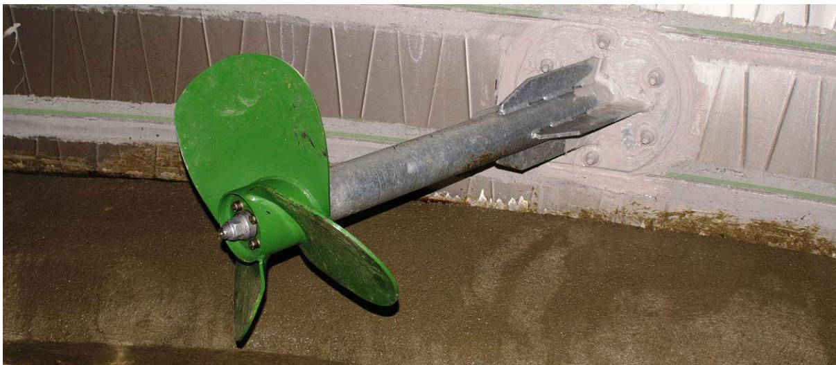
Abbildung 6: Sonderform eines Stabmixers mit kurzer Rührwelle, die knapp über dem Boden in den Behälter eingeführt ist
