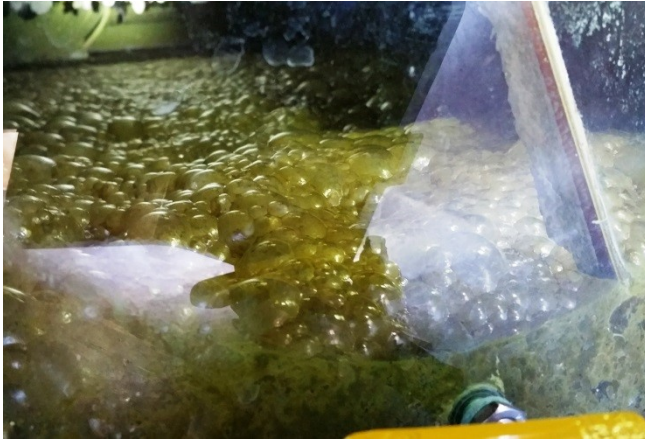
Abbildung 2: Große Schaumblasen im Fermenter gebildet durch den Einsatz von Zuckerrüben (Foto: LfL)
