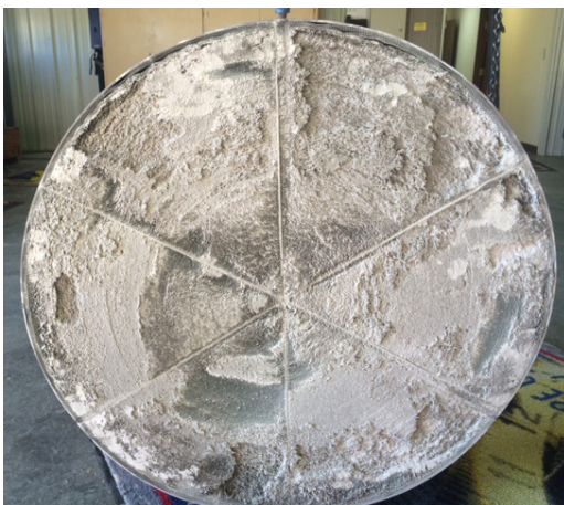
Bild 1: Katalysator mit Ascheablagerungen (Quelle: AirSonic GmbH)
