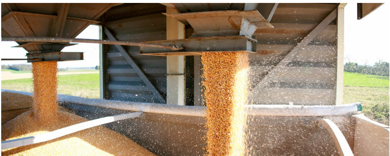
Bild 6: Damit beispielsweise Körnermais wie auf dem Bild sauber verladen werden kann, muss er bei der Erfassung über eine Siebanlage laufen und gereinigt werden. Was dabei auch z. B. bei Getreide und Raps übrig bleibt kann als Ausputz in der Biogasanlage verwertet werden (Quelle: X.BEGUET, Panorama-stock.adobe.com)
