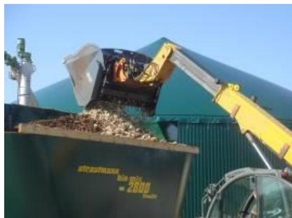
Abb. 16: vdw-Häcksel-schaufel (Foto: Schmihing)
