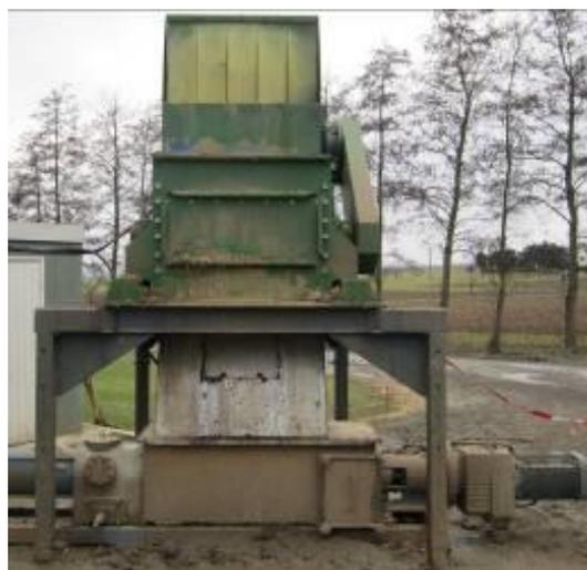
Abb. 14: Zerreißer mit hohem Durchsatz und direkt angeschlossener Pumpe, allerdings steineempfindlich (Foto: KWS)
