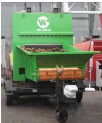
Abb. 13: Willibald-Schredder mit hoher Durchsatzleistung und „Steintoleranz“ (Foto: KWS)
