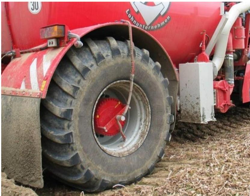
Abb. 15 Reifendruckregelanlage
