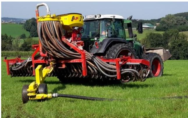
Abb. 12 Gülleverschlauchung mit Schlitz- u. Nachsaatgerät
