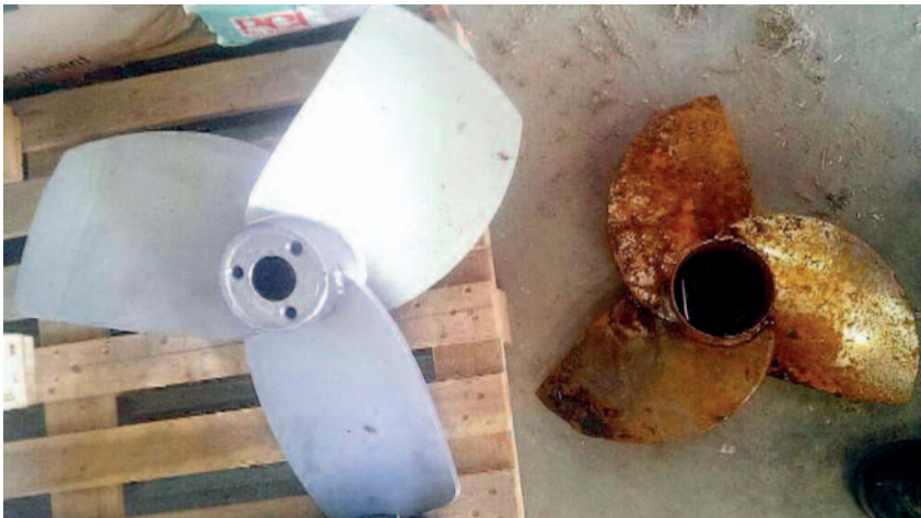
Gegenüberstellung von neuem und verschlissenen Propeller eines Schnellläufers.
