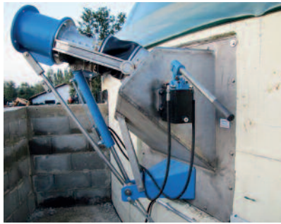
Wand-Stabmixer mit hydraulischer Vorrichtung zur Verstellung der Wellenneigung. Fotos: LfL
