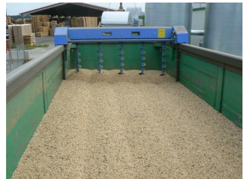
Abb. 6: Schneckenrührwerk (Foto: Martin Energietechnik)
